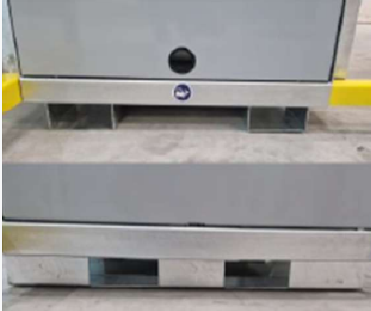
Vorkheftruckkokers en aparte ingang voor lepels van een handpompwagen
